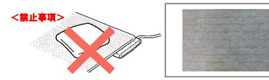
座布団・布団・クッション等保温性のよいものを長時間同じ場所にのせないでください。熱によりヒーター 線がいたみ、火災原因や故障する恐れがあります。また、ヒーター線に沿う形で床面(畳・塩ビフロアーマット・フローリング等)の変色・変形の原因になります。写真の様に表面にライン状の変色が見られる場合 はすぐにご使用を中止して下さい。
